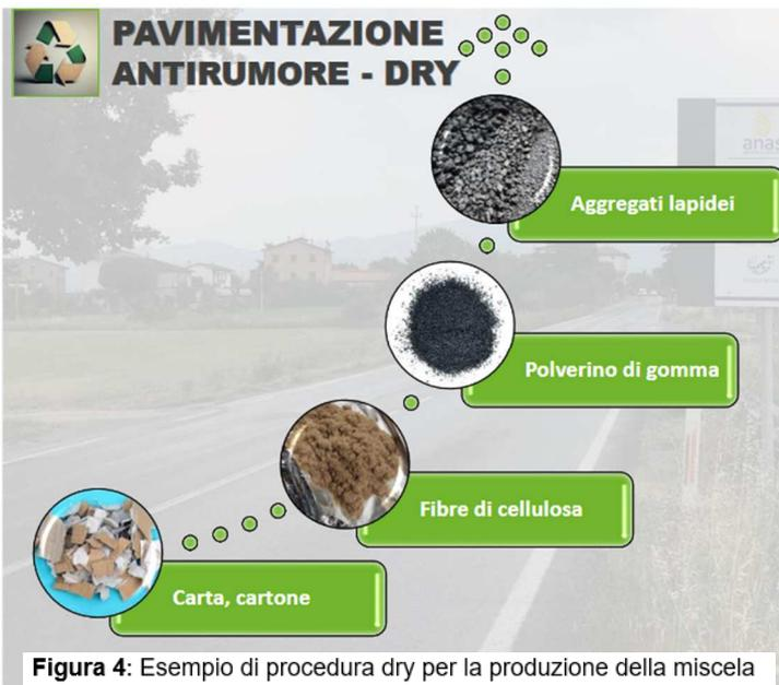
**Figura 4:** Esempio di procedura dry per la produzione della miscela
