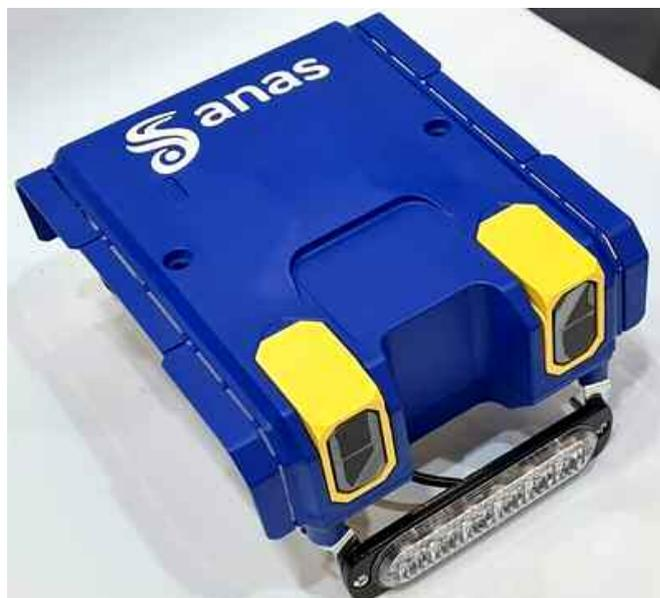
*Dispositivo tecnologico per rilievo e segnalazione urto*
