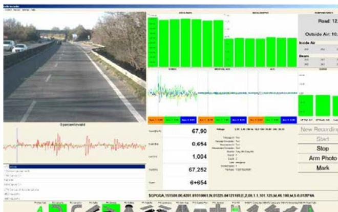
Grazie al mezzo **T.S.D. - Traffic Speed Deflectometer**, si è in grado di rilevare, in continuo, ad alta velocità fino a 70 km/h, in sicurezza e senza perturbare la normale circolazione del traffico, le **caratteristiche strutturali delle pavimentazioni stradali flessibili (portanza)**, consentendo la valutazione immediata della qualità della miscela, un efficace e puntuale controllo dei materiali utilizzati durante la realizzazione dell'opera e la verifica della vita utile dell'infrastruttura.
