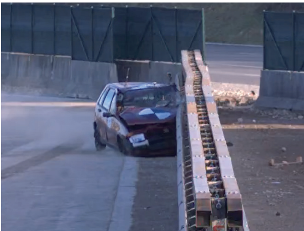
Figura 4-6: Verifica Livello di severità (prova TB11)
