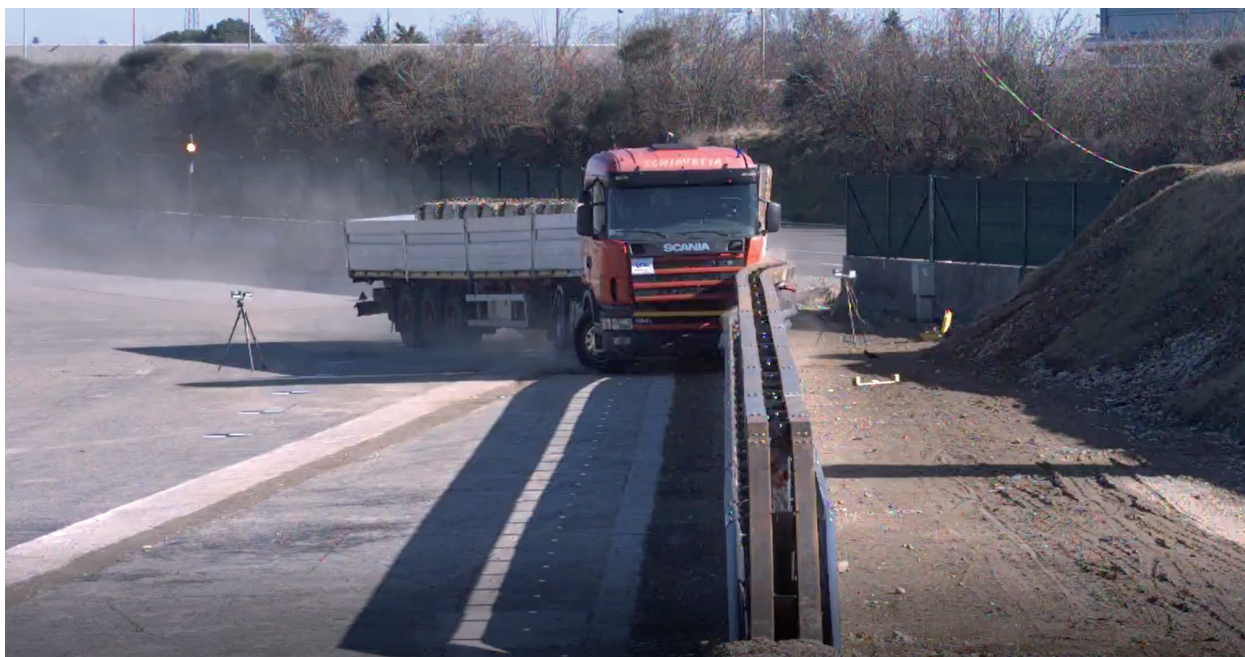
Figura 4-2: Verifica contenimento, prova tipo TB 81
