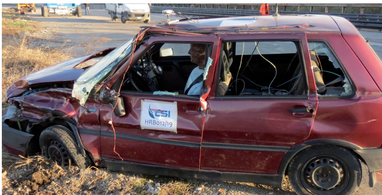
Figura 4-1: Prova di crash test (Prova TB 11)
