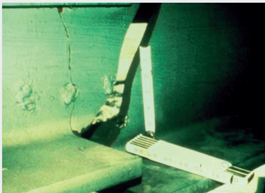
Figura 16. Fessura indotta da difetti di un foro riempito con saldatura [3].
