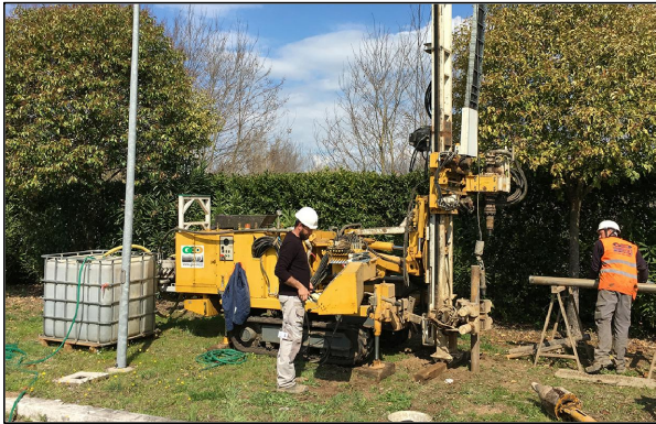
Figura 5. Carotaggio terreno
