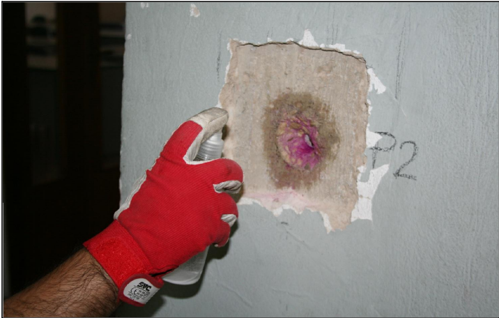
Figura 3. Prova alla fenoltalina
