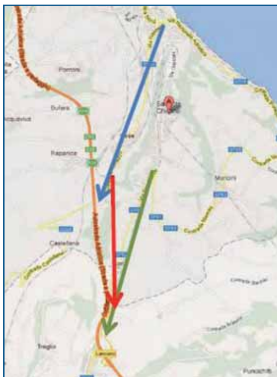
Figura 3.6 - Schema connessione trasversale tra S.S.16 all'altezza di San Vito Chietino ed il casello di Lanciano dell'A14. Vengono indicate in azzurro la S.P. 84, in verde la S.P. 83 e in rosso un'ipotesi di raccordo di nuova realizzazione tra le due.
