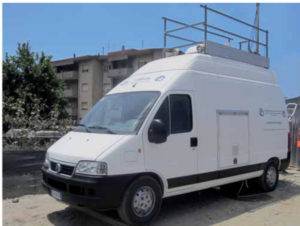
Figura 3.44 – Stazione mobile di monitoraggio ambientale: punto di misurazione degli inquinanti atmosferici: SO x , NO x , particolato (PTS, PM 10 , PM 2.5 ), PT x
