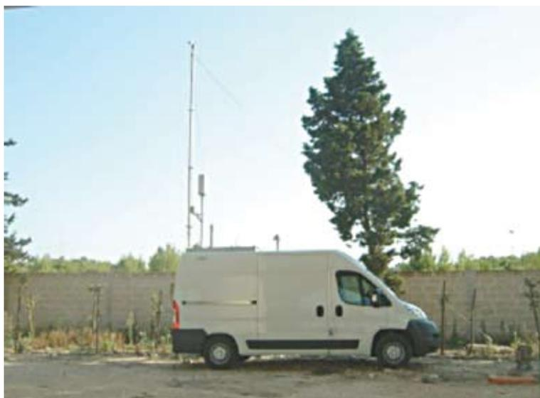
Figura 3.13 - Furgone attrezzato per il monitoraggio della qualità dell'aria
