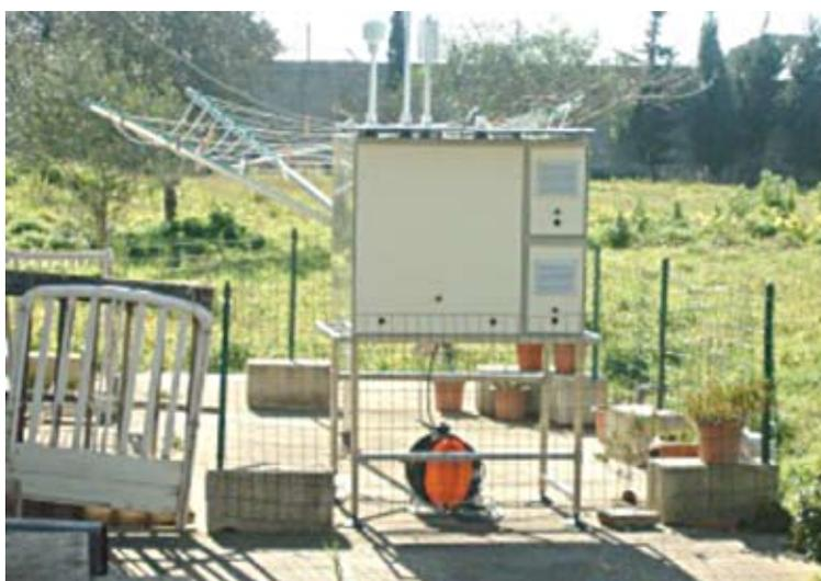
Figura. 3.12 - Stazione di campionamento automatico per materiale particolato
