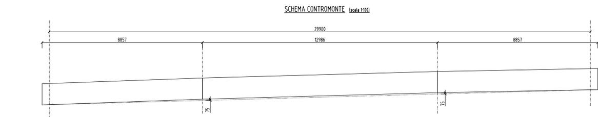
I VALORI INDICATI DELLA CONTROMONTA SONO CALCOLATI PER RECUPERARE LE DEFORMAZIONI DOVUTE AI PESI PROPRI, AI CARICHI PERMANENTI ED AL 25% DEI CARICHI ACCIDENTALI. LA CONTROMONTA VA SOMMATA ALLA LIVELLETTA DI PROGETTO
