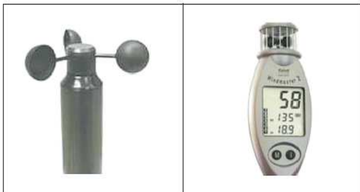
Figura 7 - Esempi di anemometri: fisso e portatile
