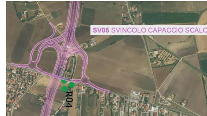
Figura 25 - Alternativa 2A, ott., Svincolo in località Ponte Barrizzo, in località Cerro e Svincolo Capaccio Scalo in località Parco Caserta. Il tracciato interferisce con le presenze archeologiche 01, 02, 03, R01, 13, 18, 19, 16 e R04.
