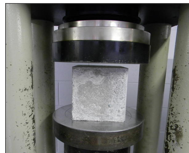
Figura 8. Prova di rottura su cubo
