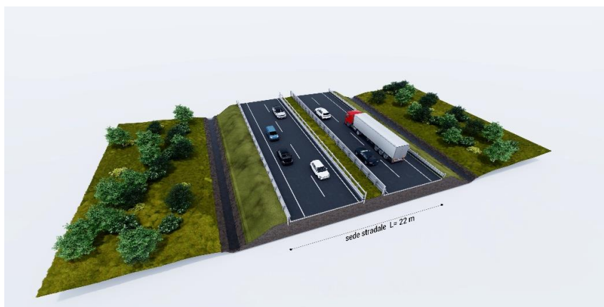
FIGURA 3-2 SEZIONE TIPO STRADA DI CATEGORIA “B”
