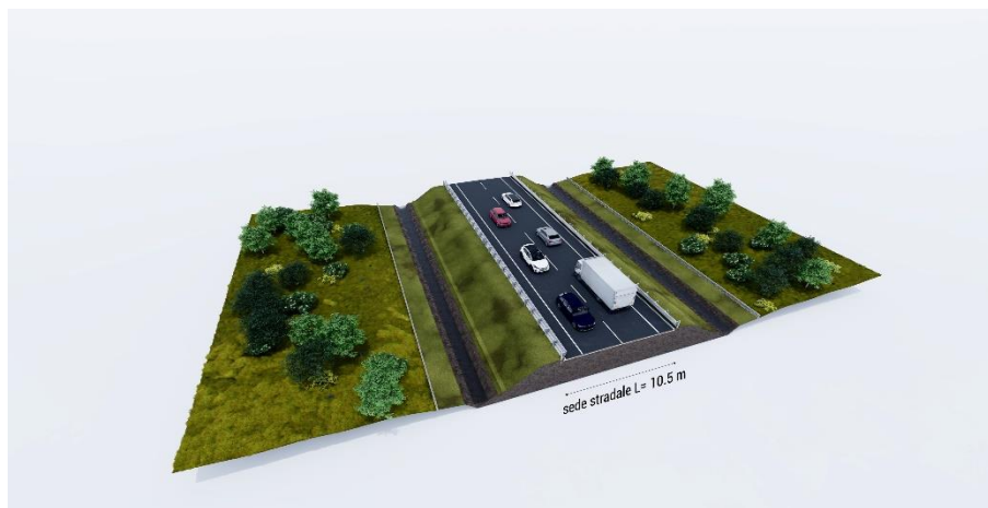
Figura 3-2 – Sezione tipo strada di categoria “C”
