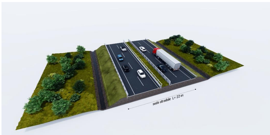
Figura 3-1 – Sezione tipo strada di categoria “B”
