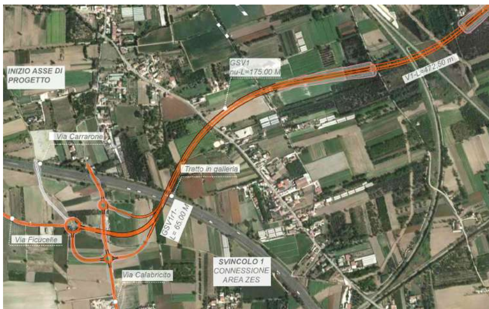
FIGURA 5-4 - NUOVO SVINCOLO DI CONNESSIONE VIABILITÀ DI PROGETTO CON DORSALE INTERNA ALL'AREA DELL'INTERPORTO (VIA FICUCELLA) E VIA CALABRITTO/SP7
